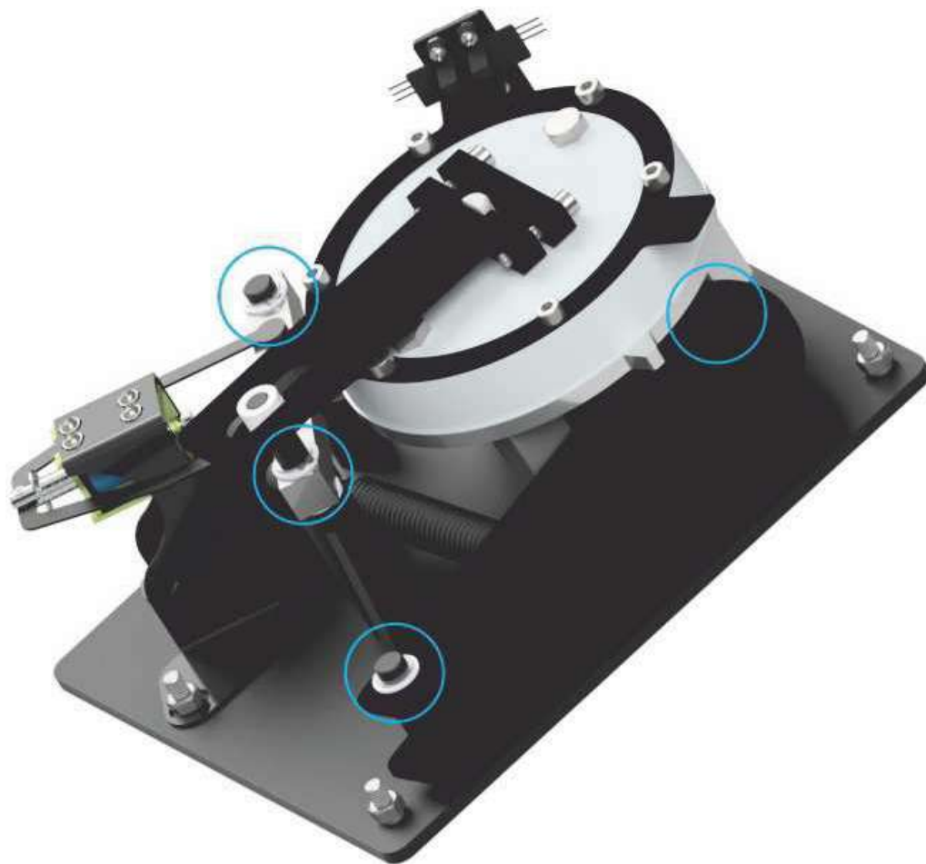
Рисунок 12.5.1 – Места смазки подвижных частей
