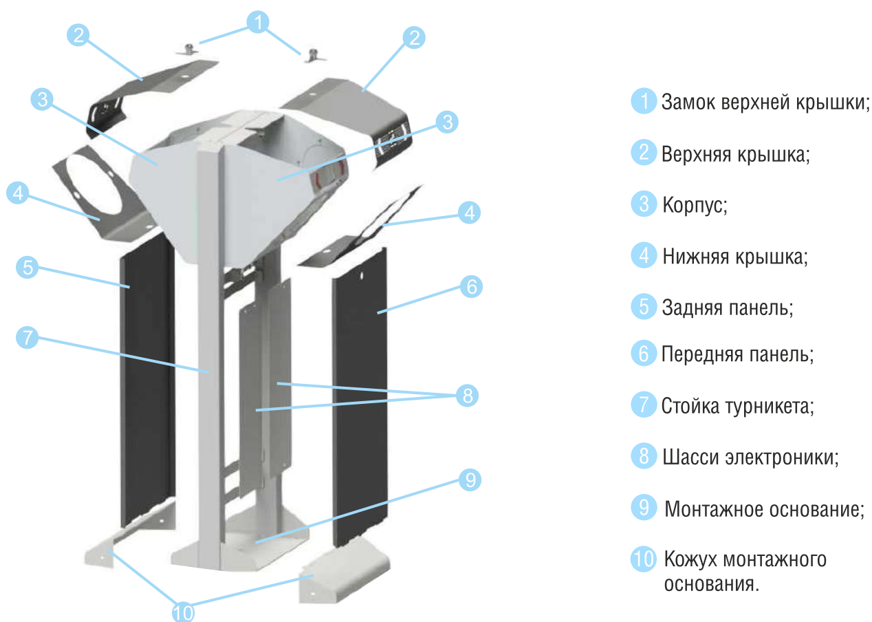
Рисунок 6.1.1 Устройство корпуса турникета
